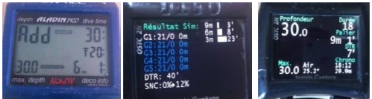
Simulation de paliers en mode surface : affichage 1er palier, paliers totaux, simulation plongée en temps réel
